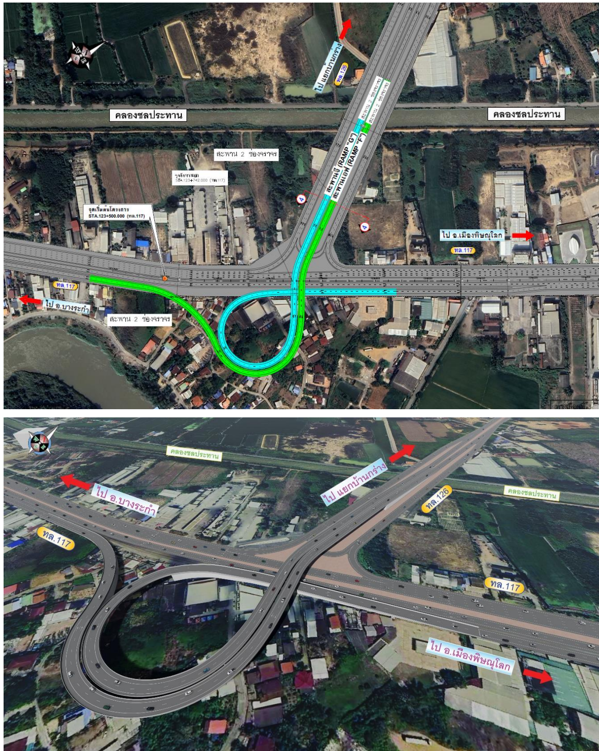
รูปที่ 5.1.3-9 รูปแบบเบื้องต้นทางเลือกที่ 4 สะพานยกระดับแบบวนข้ามทางหลวงหมายเลข 117 (แยกเอ็กซ์เรย์)
