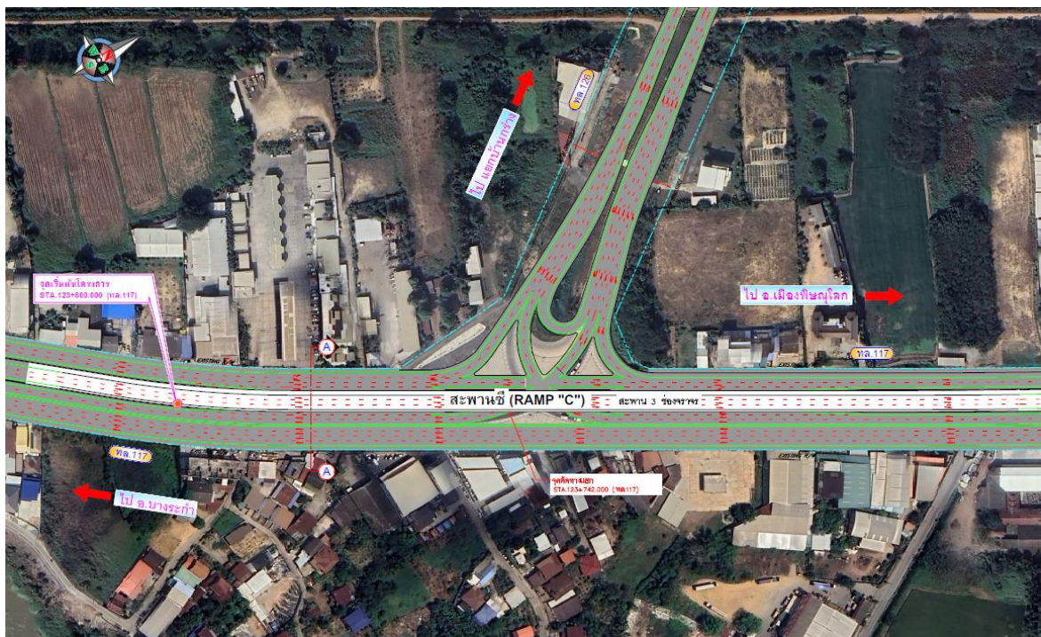
รูปที่ 5.1.3-8 รูปแบบเบื้องต้นทางเลือกที่ 3 สะพานยกระดับแบบข้ามทางแยกตามแนวทางหลวงหมายเลข 117 (แยกเอ็กซ์เรย์)
